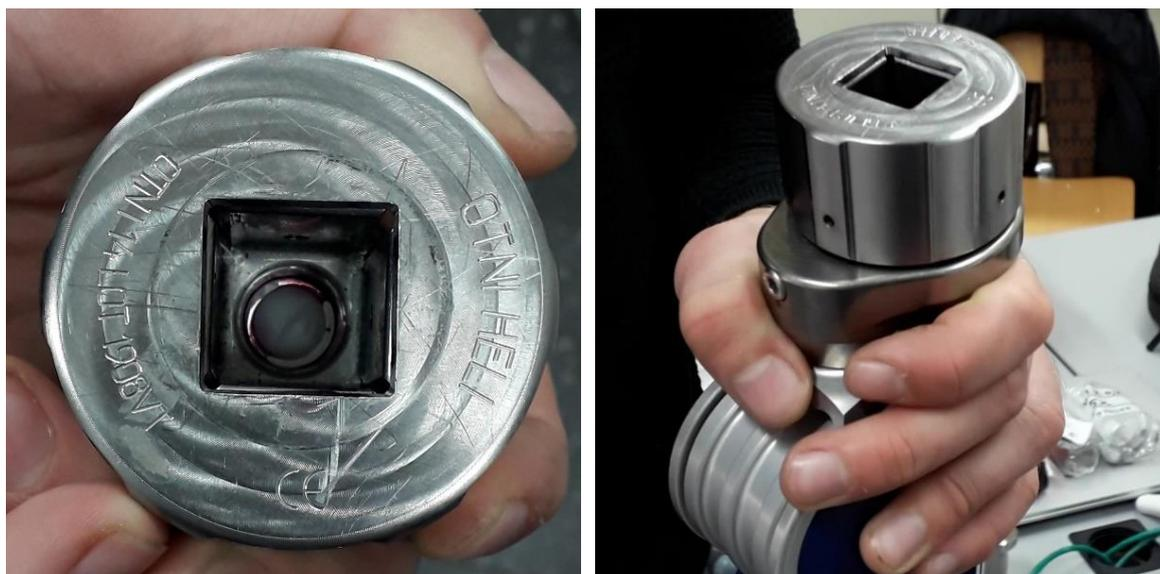
Figure 12 e 13 – Visione dell'interno del connettore femmina con frenafili applicato attorno al foro di ingresso della vite M14 (a sinistra) e visione dei fori laterali che accolgono le viti M2 (a destra).
