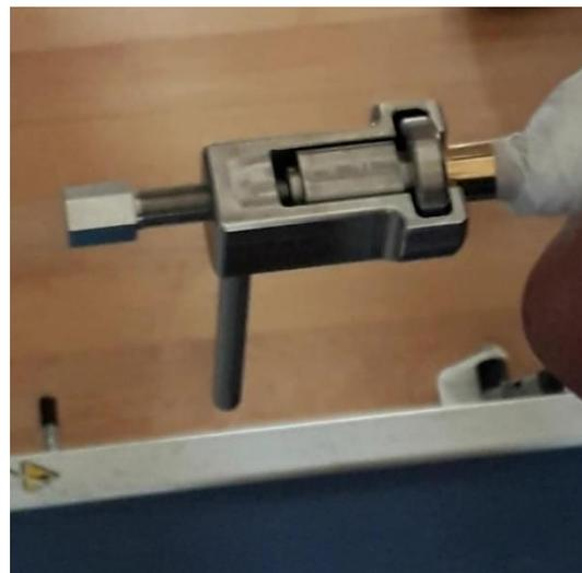
Figure 10 e 11 – Svitare la vite M14 del connettore maschio (a sinistra) e rimuovere il connettore attraverso l'apposito estrattore (a destra).
